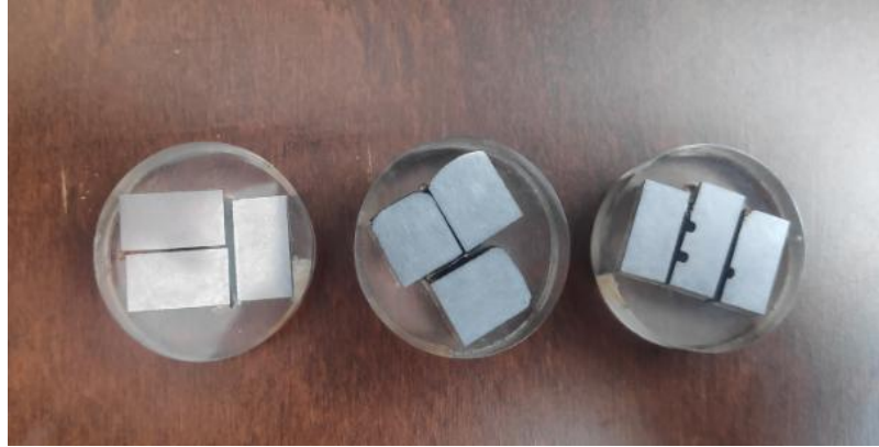
Şekil 3.12: Mikroyapı incelemesi için bakalit kaplama yapılan numuneler.
